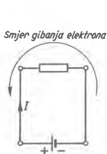
Sl. 2.11. Dogovorom usvojen način označivanja smjera struje I .
