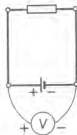
Sl. 2.12. Paralelno priključivanje voltmetra.
