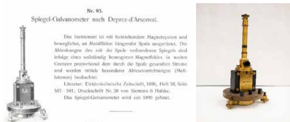
Sl. 5. Zrcalni galvanometar u ponudi tvrtke Siemens&Halske 1906. godine i instrument u Središnjoj knjižnici FER-a
