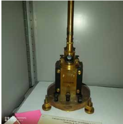
Sl. 28. Zrcalni galvanometar Siemens Halske
