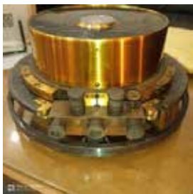
Sl. 7. Univerzalni galvanometar korišten kao Wheatstoneov most za vježbu br. I.
