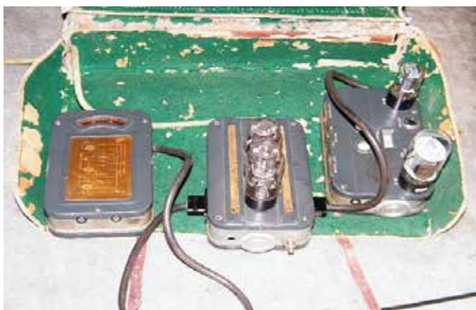
Sl. 13.: Sovjetska špijunska stanica Tensor, prijemnik (lijevo), ispravljač (sredina) i odašiljač (desno) u otvorenoj aktovci
