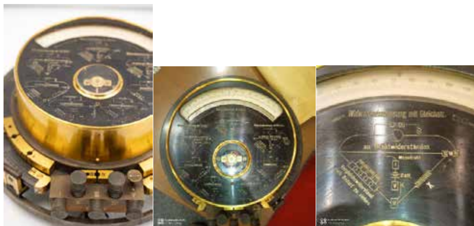
Sl. 9. Univerzalni galvanometar korišten kao Wheatstoneov most na I vježbi kod Josipa Lončara iz predmeta Električna mjerenja (EM) u ak. godini 1938./1939. a) vanjski izgled, b) pogled s gornje strane, c) spoj instrumenta kao Wheatstoneov most za I. vježbu iz EM
