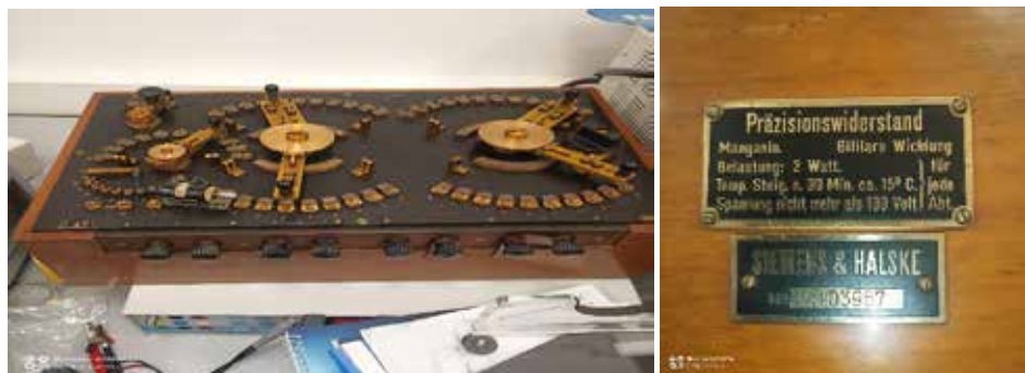
Sl. 1. Rapsov kompenzator, u šezdesetim i sedamdesetim godinama jedan od najvažnijih instrumenata u znanstvenom i laboratorijskom radu Zavoda za osnove elektrotehnike i električna mjerenja
