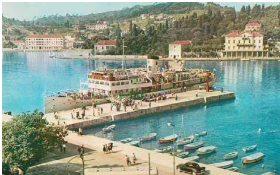
Sl. 8. Brod Partizanka 16 izgrađen je 1931. u brodogradilištu u Engleskoj, imao je 1726 bruto tona, duljine 82 metra, snage 2832 kW.
