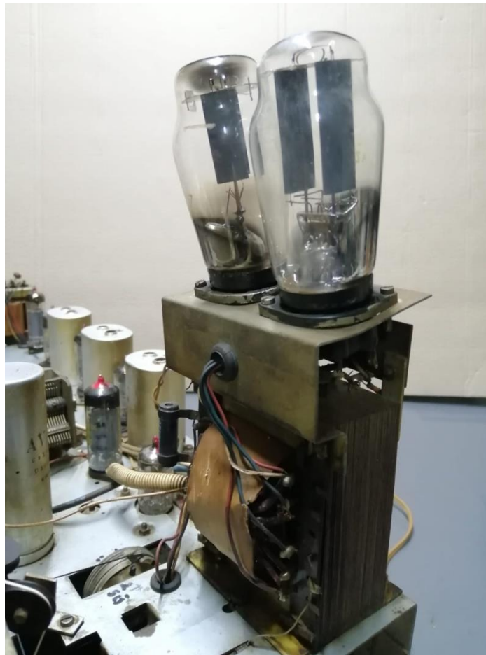
Sl.15.: Ispravljačke cijevi radio aparata RIZ 594 UKV postavljene na mrežni transformator [3]
