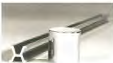
Međunarodni kilogram i nekadašnji prametar (koji je danas samo muzejski primjerak) u Međunarodnom uredu za utege i mjere
