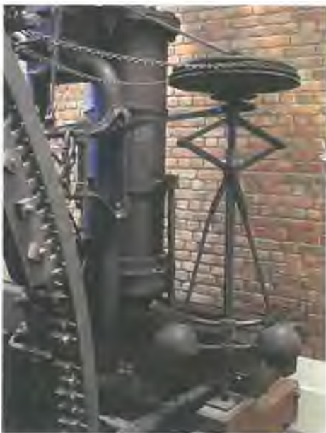
Watt je za parni stroj konstruirao centrifugalni regulator pare s kuglama
