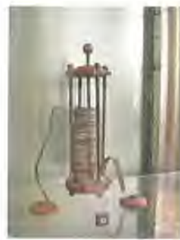
Voltin stup – prva električna baterija
