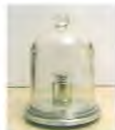
Hrvatski prakilogram, državni etalon mase koji je pohranjen u Državnome zavodu za mjeriteljstvo
