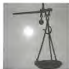
Vaga nejednakih krakova s pomičnim utegom, tzv. kantar, stoljećima se rabila na tržišnicama
