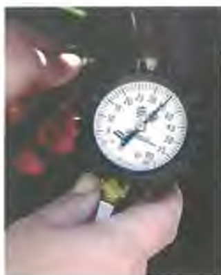
Tehnički barometar za mjerenja tlaka u zračnicama kotača vozila
