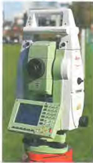
Računalno upravljani elektronički teodolit s daljinomjerom, tzv. totalna stanica ili tahimetar
