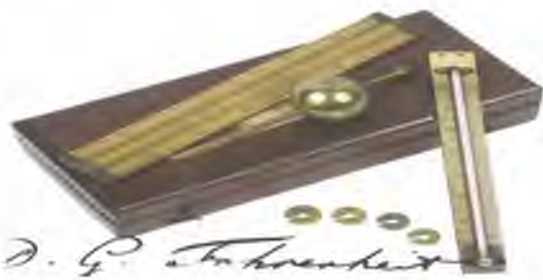
Jedan od samo tri sačuvana izvorna Fahrenheitova termometra, načinjen nekoliko godina poslije 1714. godine (Muzej Boerhaave u Leidenu u Nizozemskoj)
