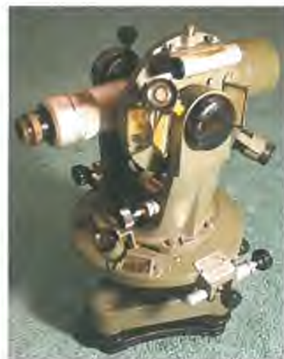
Klasični teodolit, geodetski instrument za određivanje kutova između pravaca u postupku triangulacije
