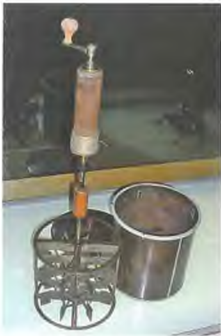
Jouleov uređaj za određivanje mehaničkoga ekvivalenta topline iz 1845. godine
