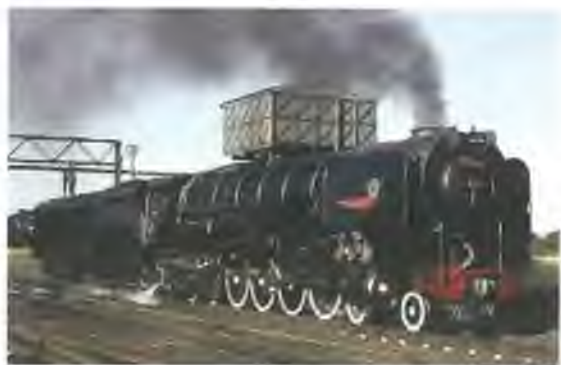
Primjer tehničke pretvorbe toplinske energije oslobođene oksidacijom fosilnoga goriva u mehanički rad – parna lokomotiva
