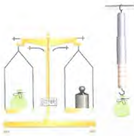
Dva bitno različita načina određivanja težine, a posredno mase u gravitacijskome polju; lijevo: vagom s utezima, desno: dinamometarskom vagom
