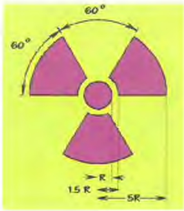
Međunarodni znak ionizirajućeg zračenja prema normi ISO 361 1975(E) – rabe se i mnoge inačice toga znaka
