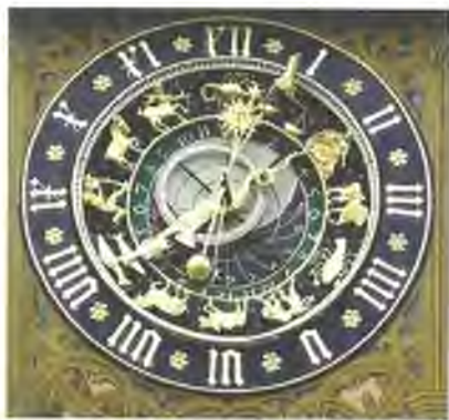
Složeni astronomski sat na vijećnici u Ulmu, s 12-satnim pokaznikom na kojemu su sati označeni rimskim brojkama od I. do XII. te s 24-satnim pokaznikom na kojemu su sati označeni arapskim brojkama (2 × 12) iznad kojih kruže četiri kazaljke
