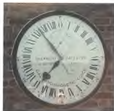
Sat na vanjskome zidu zvjezdarnice u Greenwichu pokraj Londona, s 24-satnim pokaznikom na kojemu je ponoć označena nulom, a ostali sati rimskim brojkama od I. do XXIII., pokretan je električnim impulsima s glavnoga sata u unutrašnjosti (danas ga pokreće suvremenija, a ne izvorna naprava), prvi je sat koji je javnosti pokazivao griničko vrijeme (Charles Shepherd, engleski precizni urar, 1852. godine)
