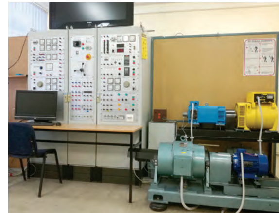
Ispitna stanica za električne strojeve i pogone s motor-generatorskom postavom i dinamo-vagom u laboratoriju za električne strojeve i pogone 0-22
