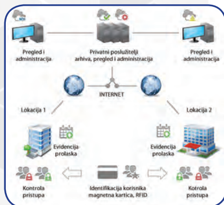
Sl. 1 Shema elektronske kontrole pristupa
